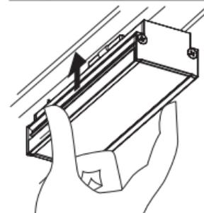
1. Remova a capa de proteção dos contatos elétricos;
